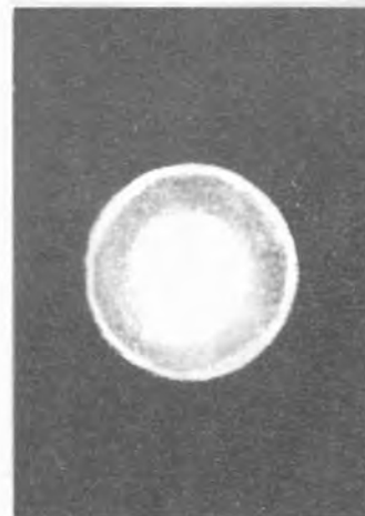
(d) 48 KV pulse (770 Joules inp.Elec.Energy) 210 Torr Xenon in flashtube 100 Torr C_3F_7I vapour in laser cell.
