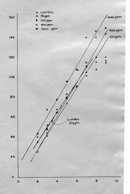
THE EFFECT OF PICLORAM ON THE NITRIFICATION PROCESS
